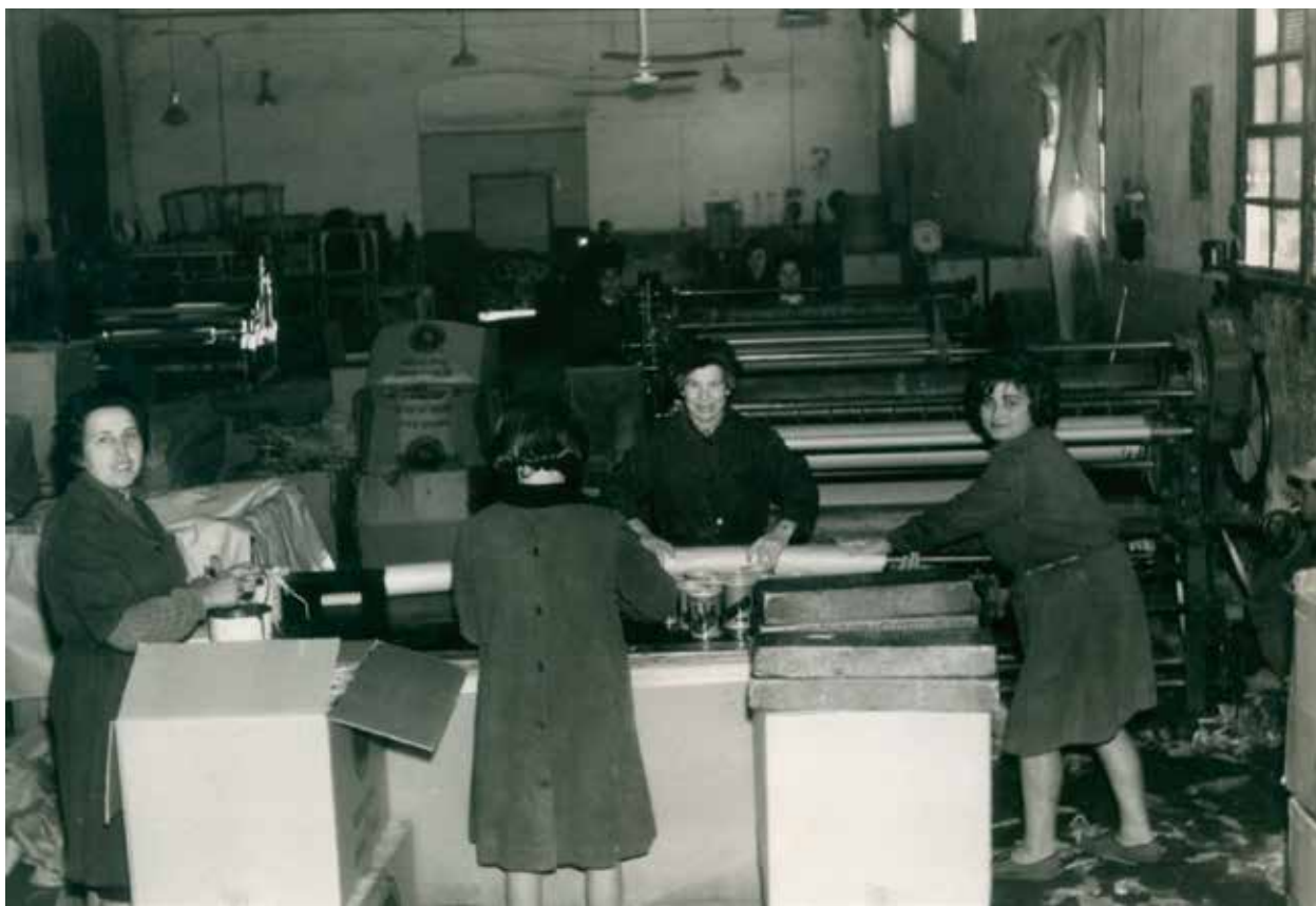
Any 1968. Fàbrica de paper. A la foto veiem com les dones treien els rotllos de paper del cilindre ja tallats a la mida estàndard. Allí mateix posaven l'embolcall de la marca El Elefante. D'esquerra a dreta: Enriqueta Capsir, Eliseta Álvarez (d'esquenes), Nieves Ferri (la Conductora) i Milagrín González.
